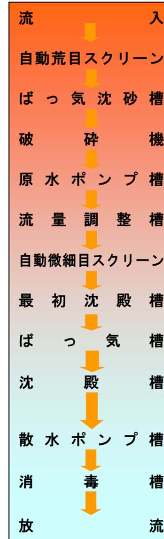
・汚水中の夾雑物等を除去し、原水ポンプの破損及び後段の処理槽等の機能低下を防止します。
