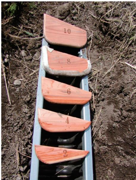
水田水位調整用の堰板
