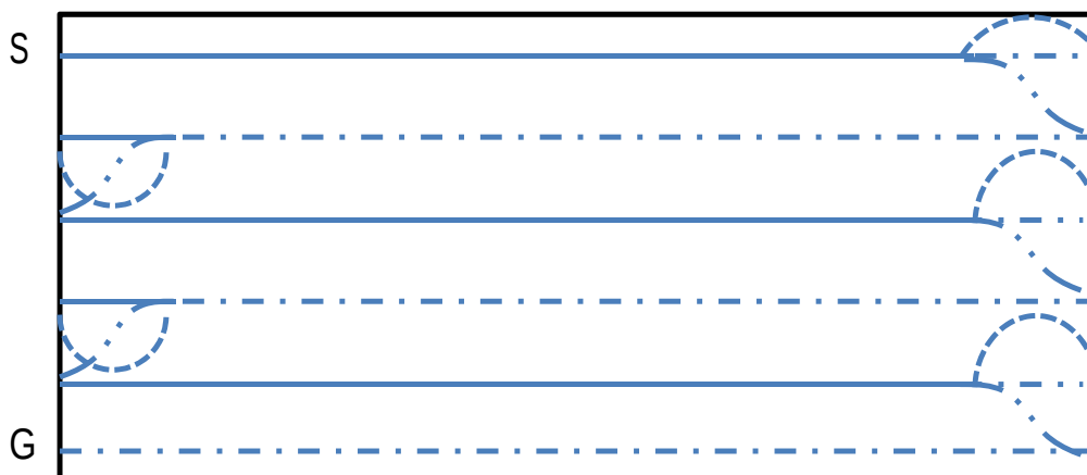
図5-5 改良型スラリースプレッダの作業経路
