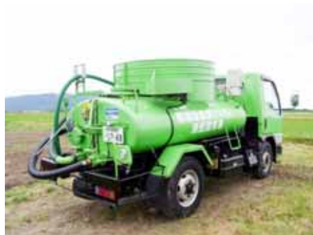
写真 5-1 バキュームカー
