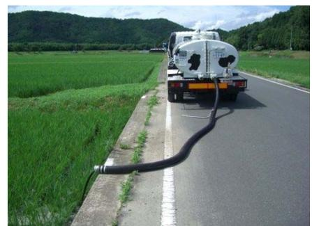
写真 3-6 バキュームローリーによる流し込み
