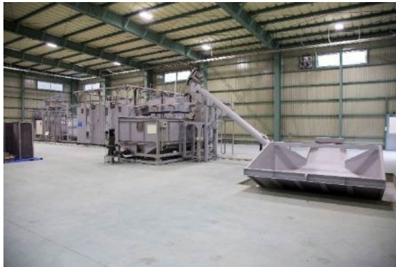
写真 6.7.4 大型メタン発酵装置 処理能力 5～10t/日
