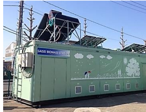
写真 6.7.5 小型メタン発酵装置 処理能力 0.3～0.5 t/日
