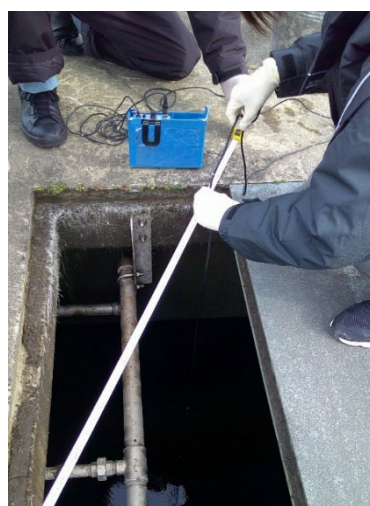
写真 3-6-10 沈殿槽センターウエル近傍 底部の汚泥界面の調査状況
