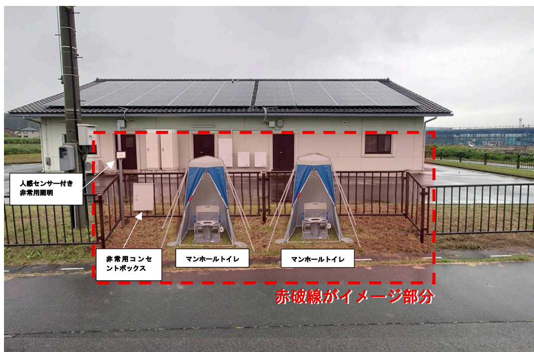
写真 5-2-1 マンホールトイレ 2 基 設置イメージ
