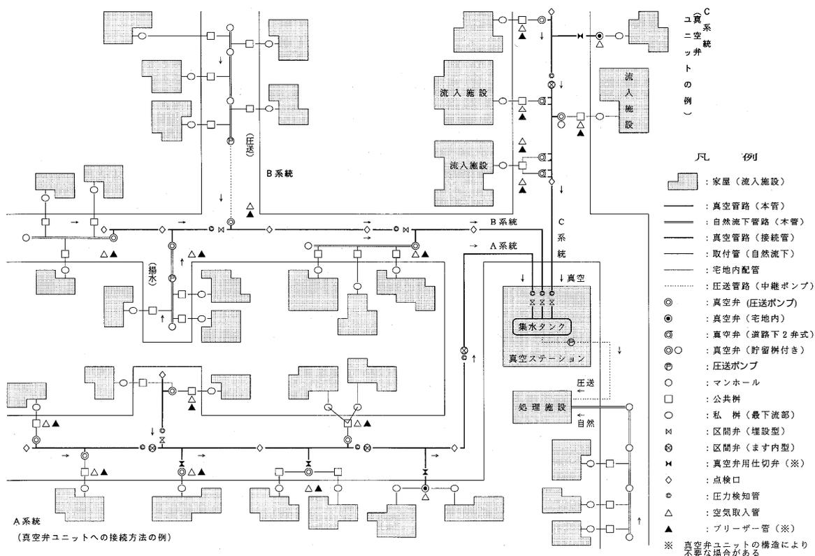
図2-4-5 真空管路の構成(例)
