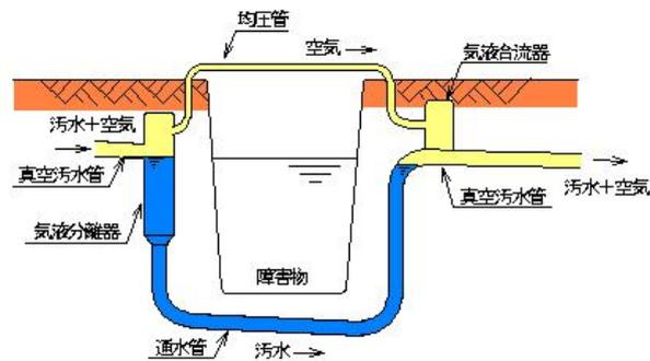
図 2-4-9 均圧管付き伏せ越し（例）
