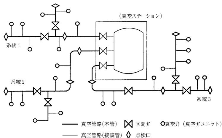
図2-4-2 真空式管路システムの配管（例）
