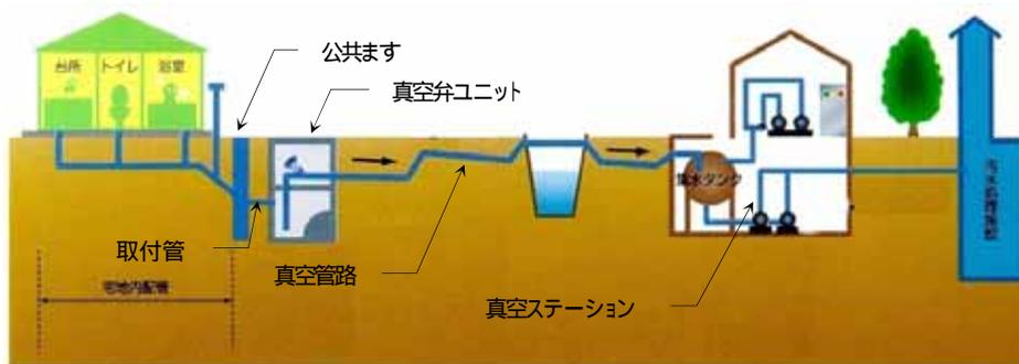
図2-4-1 真空式管路システムの構成概要
