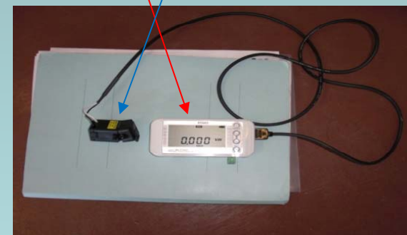
制御盤への電力量計の セット状況
