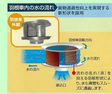
省エネ機種：高効率ノンクロックタイプ(異物通過型)
