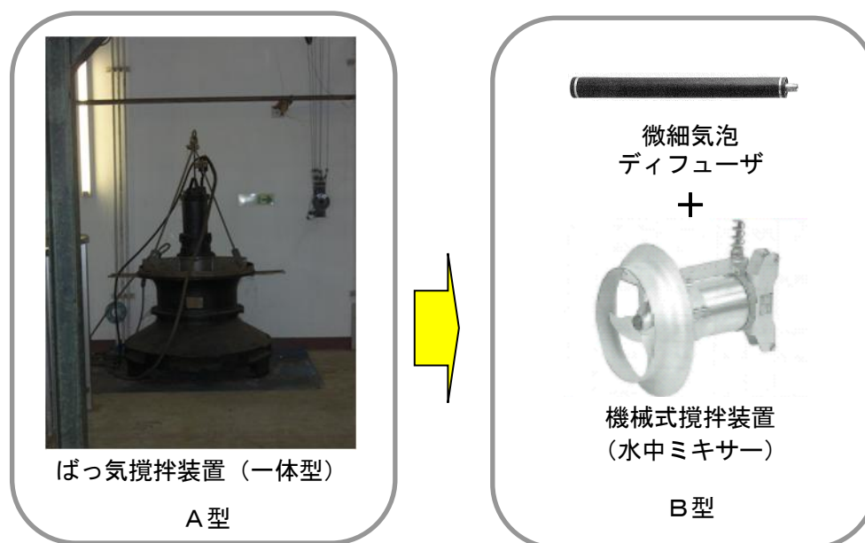
図 4.3.1 生物反応槽のばっ気と攪拌を行う装置
