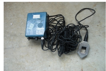
写真 5.1.3 界面計の事例
